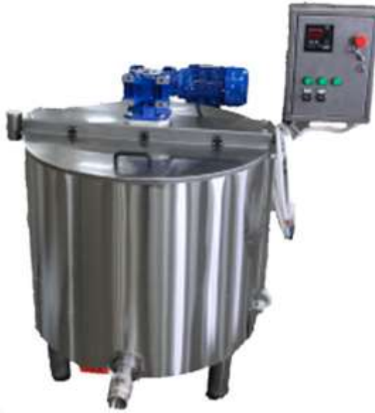
Рис. 1.6 – Електричний масляний варильний котел КВ з мішалкою, об'ємом 250 дм 3
