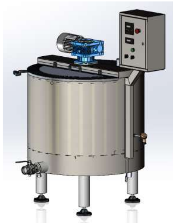
Рис. 3.1 – Електричний масляний котел КВ-250 без механізму перекидання
