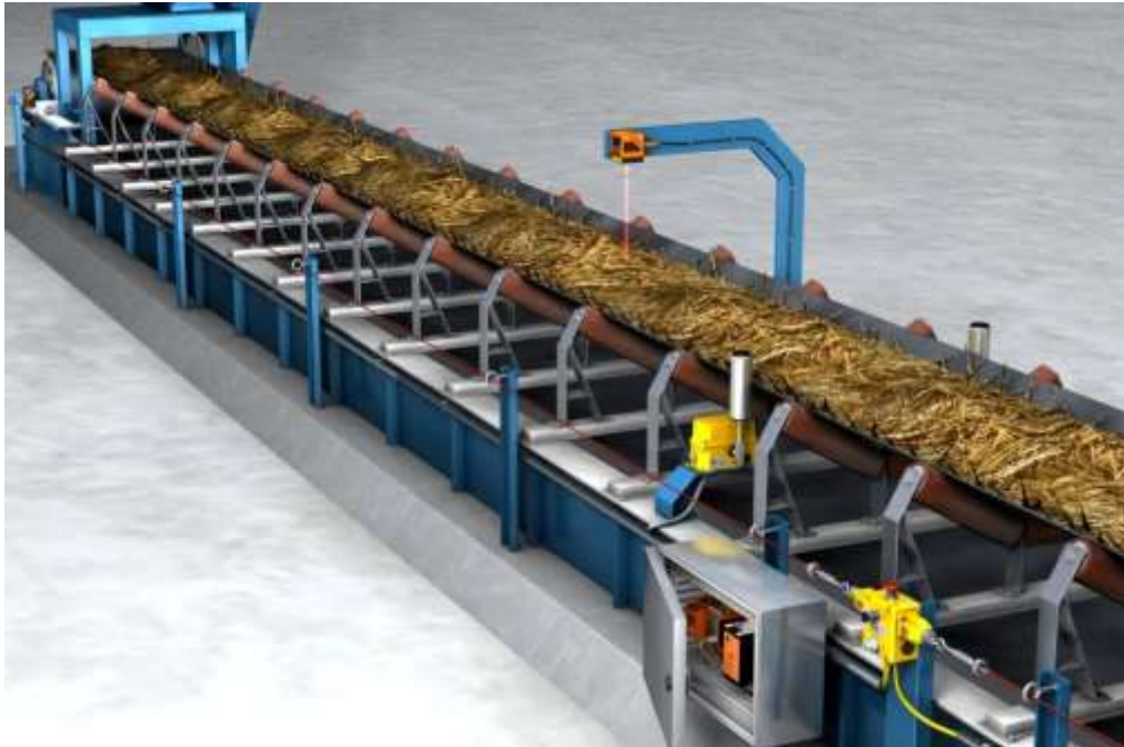
Рис. 2.3 – Конвеєр з встановленими сигналізаторами перекосу стрічки
