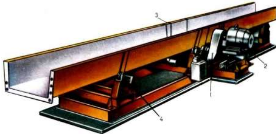
Рис. 1.8 - Вібраційний (коливальний) конвеєр: 1 – нерухома рама; 2 – привод; 3 – жолоб; 4 – пружний елемент.
