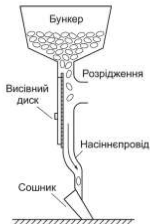
Рис. 2.1 - Схема висівного апарата пневматичної сівалки
