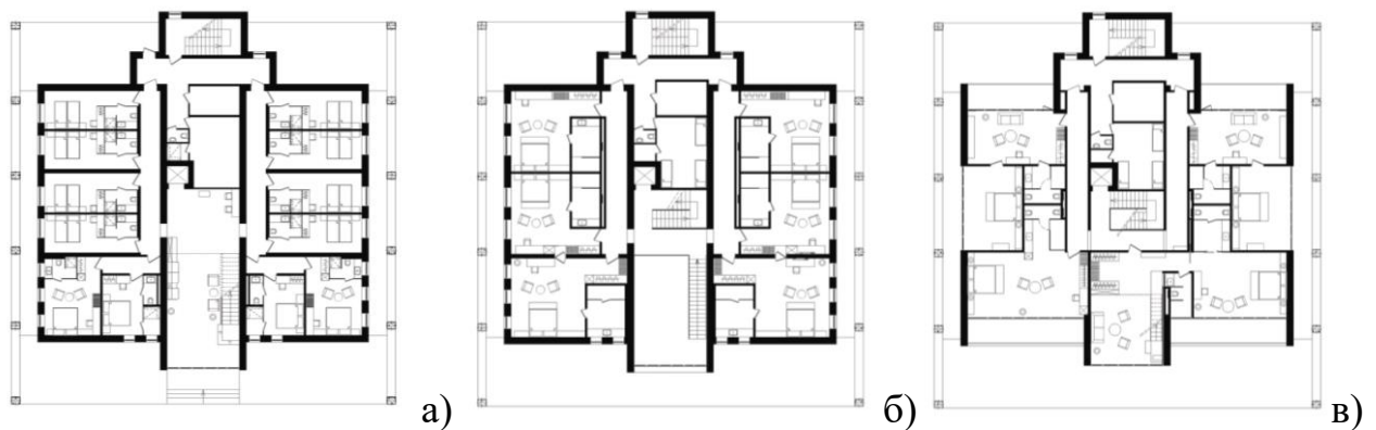
Рис. 16 Плани а) першого, б) другого та в) третього поверхів готелю в Релакс Парку «Верхоли»
