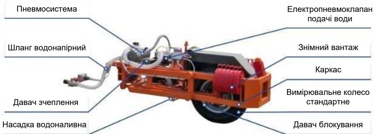
Рисунок 1.5 – Загальний вигляд динамометричного причепа ПКРС-2 РДТ
