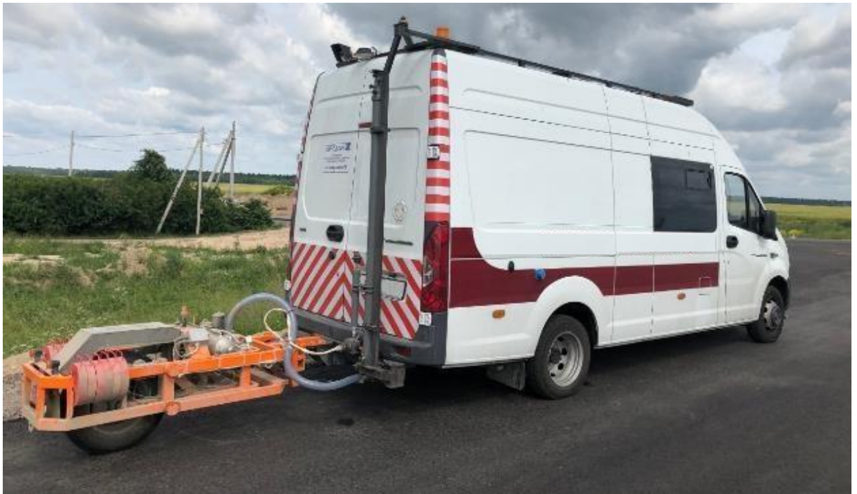
Рисунок 1.4 – Дорожня лабораторія КП-514 РДТ з динамометричним причепом типу ПКРС-2 РДТ
