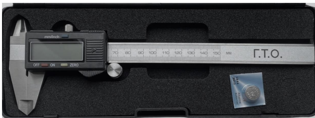
Рисунок 3.6 – Електронний штангенциркуль із глибиноміром ГТО ШЦЦ-I-150
