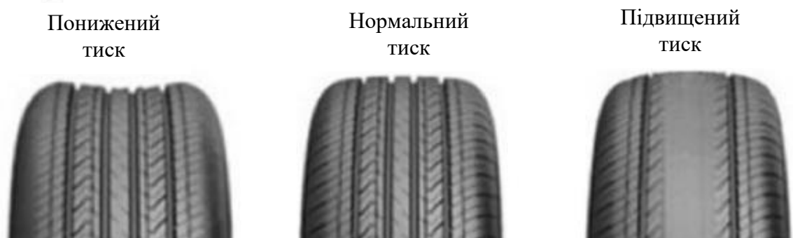
Рисунок 1.11 – Спрацювання протектора шини залежно від тиску
