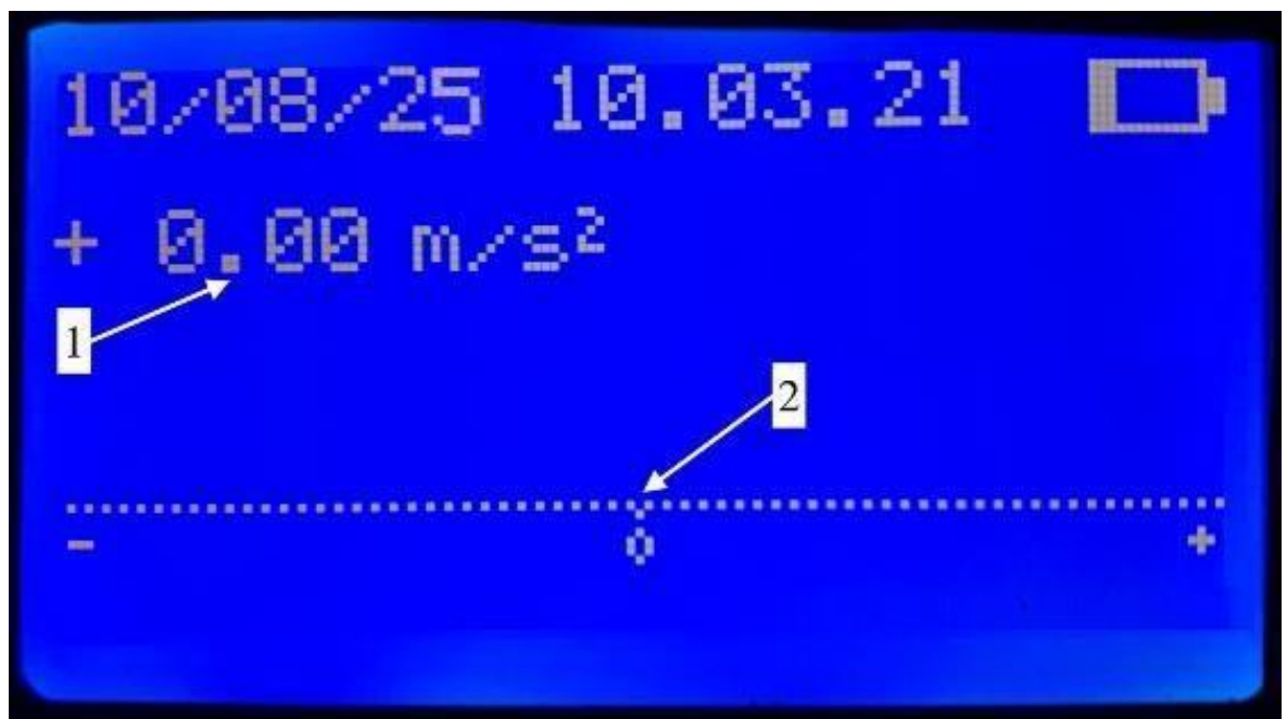
1 – цифрове зображення значення прискорення; 2 – графічне позначення прискорення
