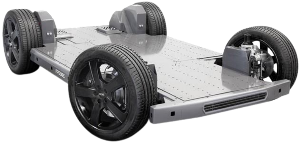
Рисунок 1.2 – Платформна компоновка електромобіля з батареєю в підлозі
