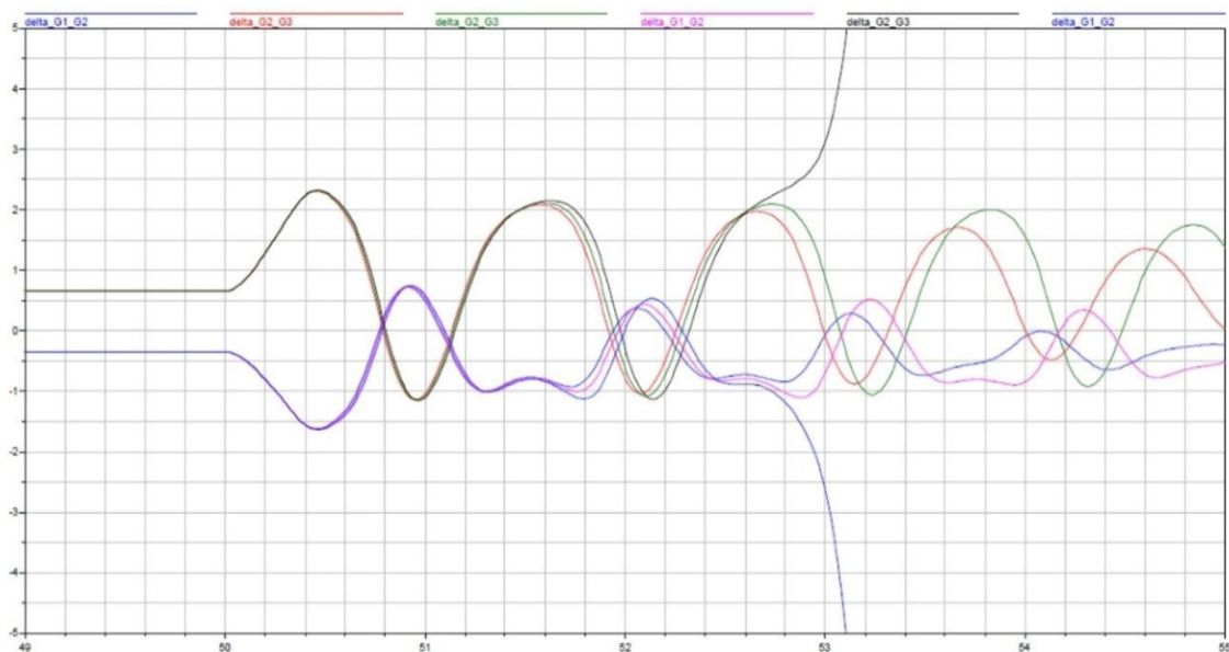
Рисунок 3.7 – Зміна електромеханічних кутів генераторів при двофазному КЗ
