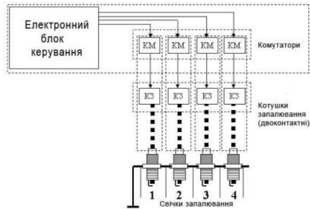
Рисунок 1.6 - Незалежна система запалювання [15].
