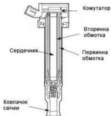
Рисунок 1.9 - Модуль системи запалювання «COP».
