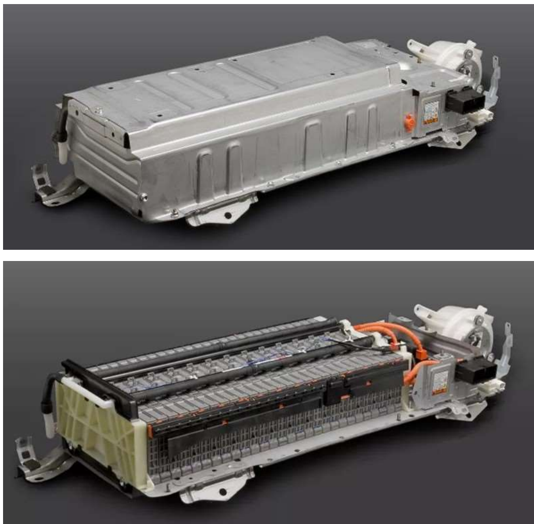
Рисунок 1.9 - Нікель-металогідридні акумулятори автомобілів Toyota Prius, Honda Insight
