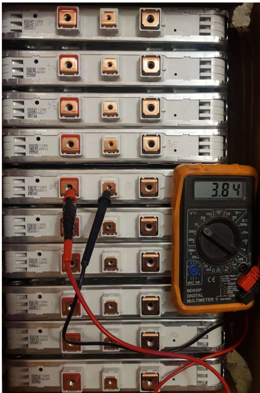
Рисунок 3.3 – Визначення основних параметрів модулів батареї
