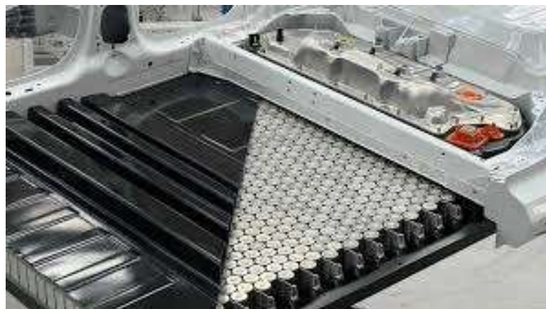
Рисунок 1.11 - Батарея Model Y Long Range (4416 елементів типу 21700)
