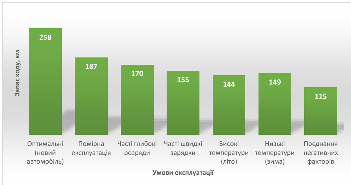
Рисунок 2.4 – Залежність запасу ходу та ємності батареї Nissan Leaf
