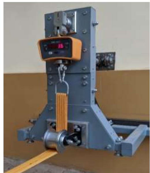
Рисунок 3.1 - Формування методики та обладнання для проведення визначення зусилля буксирування
