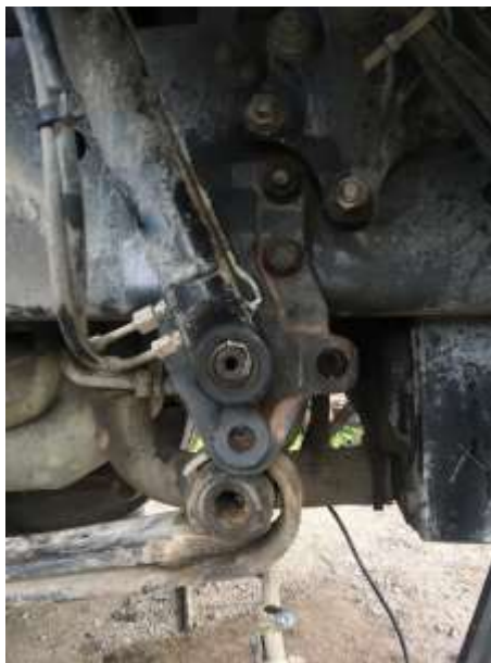
Рисунок 3.2 – Застосування гумових проставок задніх ресор
