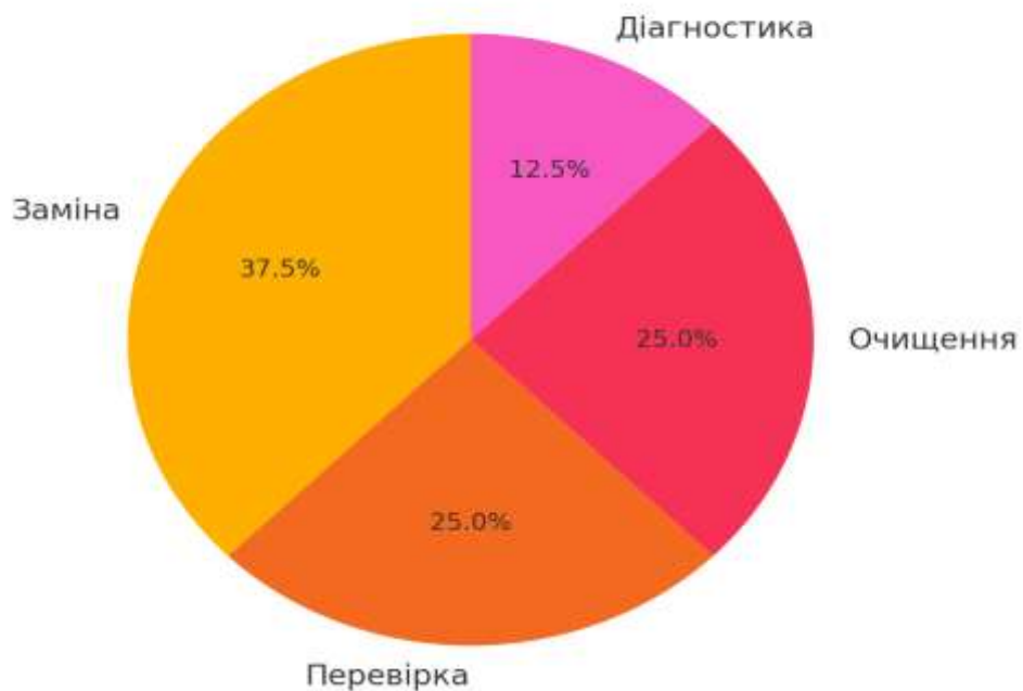
Рисунок 3.2 – Розподіл видів операцій технічного обслуговування системи Monojetronic на пробігах до 500 000 км
