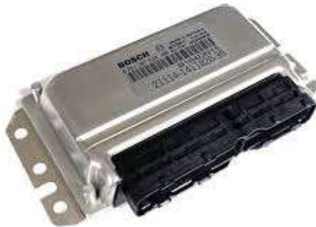
Рисунок 1.2 - Електронний блок керування Сигнали, що подаються до ЕБК, включають наступне:
