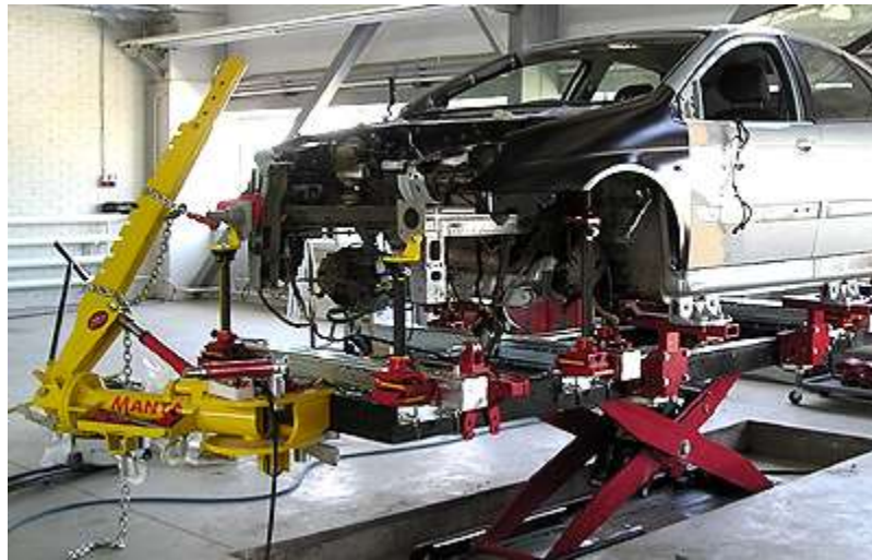
Рисунок 3.11 - Стапель для рихтування автомобілів
