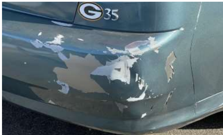
Рисунок 3.1 - Руйнування захисного покриття
