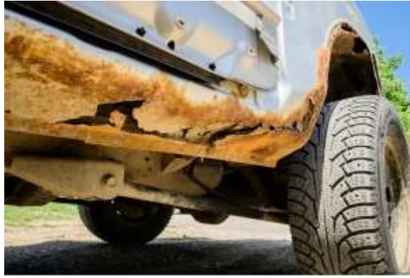
Рисунок 3.2 - Погано захищені від корозії порожнини
