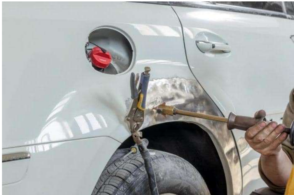
Рисунок 3.10 - Виправлення вм'ятини на автомобілі
