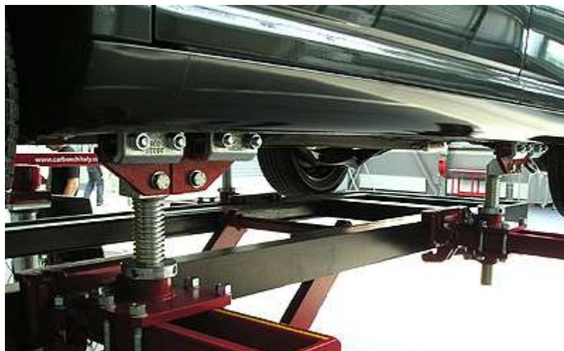
Рисунок 3.12 - Кріплення автомобіля на чотирьохпортовому стапелі
