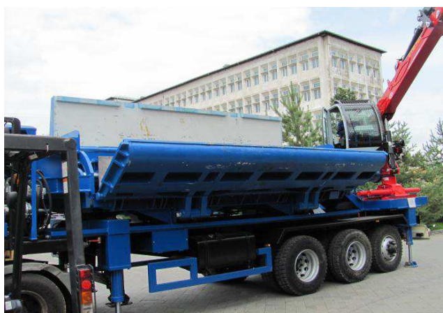
Рисунок 1.2 – Загальний вигляд мобільного преса, який використовують при зборі металобрухту
