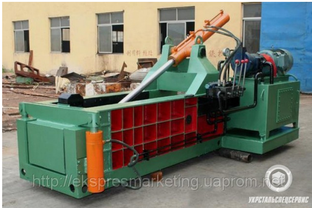
Рисунок 1.1 – Загальний вигляд преса для виготовлення пакетів брухту чорного металу [10]
