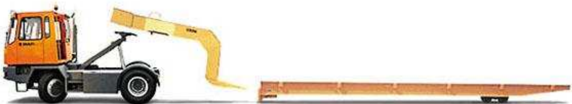
Рисунок 1.1 – Використання гузнека для зчіплення тягача з низькорамним тралом
