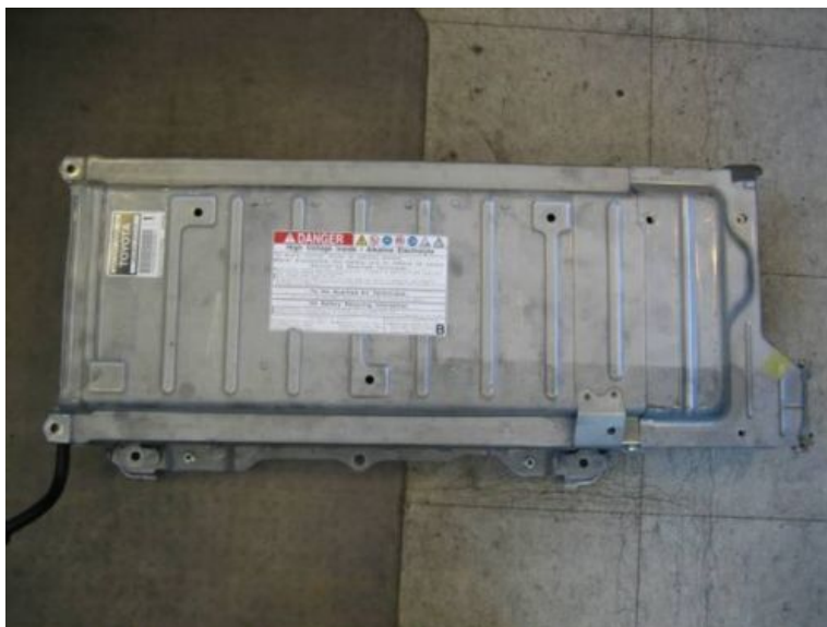
Рисунок 1.4 – Загальний вигляд високовольтної акумуляторної батареї Тойота Пріус 20
