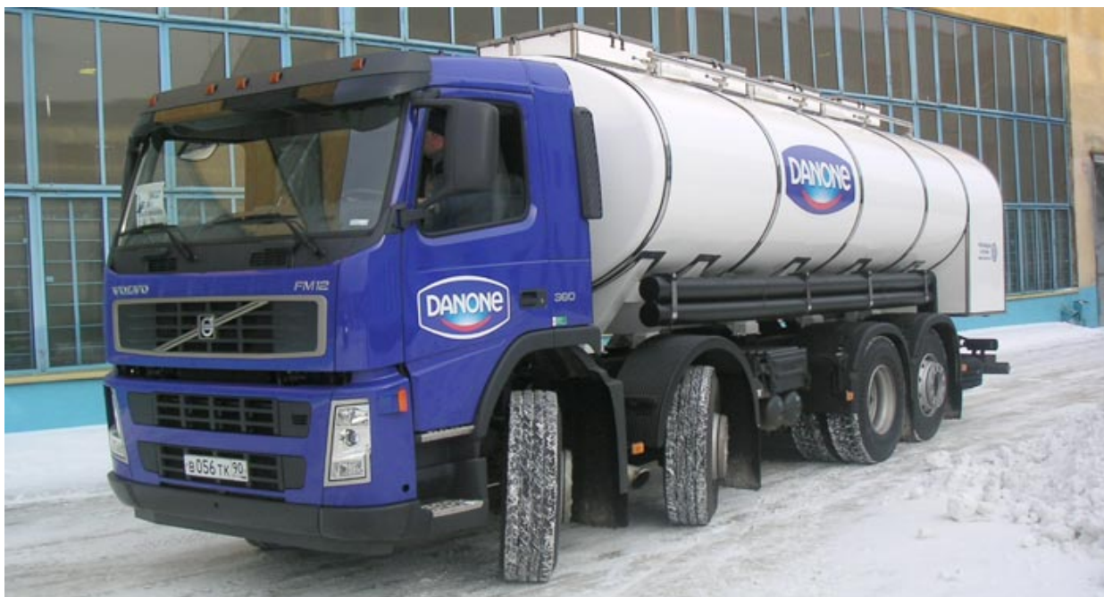
Рисунок 1.3 – Автоцистерна БЦМ-139 для рідких харчових продуктів
