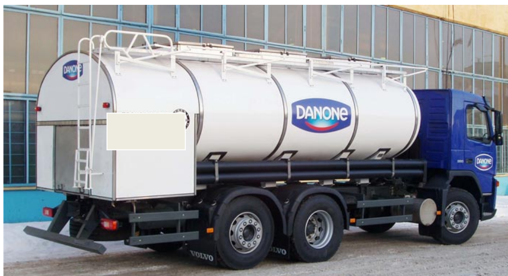
Рисунок 1.2 – Автоцистерна БЦМ-138 для рідких харчових продуктів
