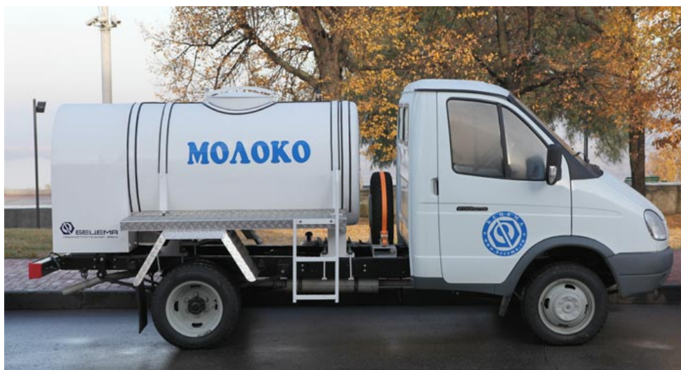
Рисунок 1.6 – Автоцистерна БЦМ-226 для рідких харчових продуктів
