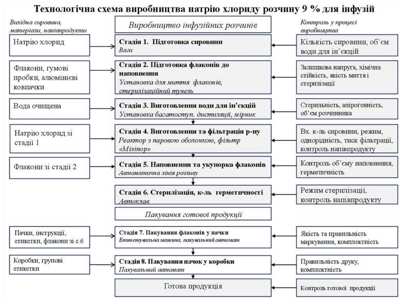
Рис.2.4. Технологічна схема виробництва розчинів для ін'єкцій на прикладі хлориду натрію
