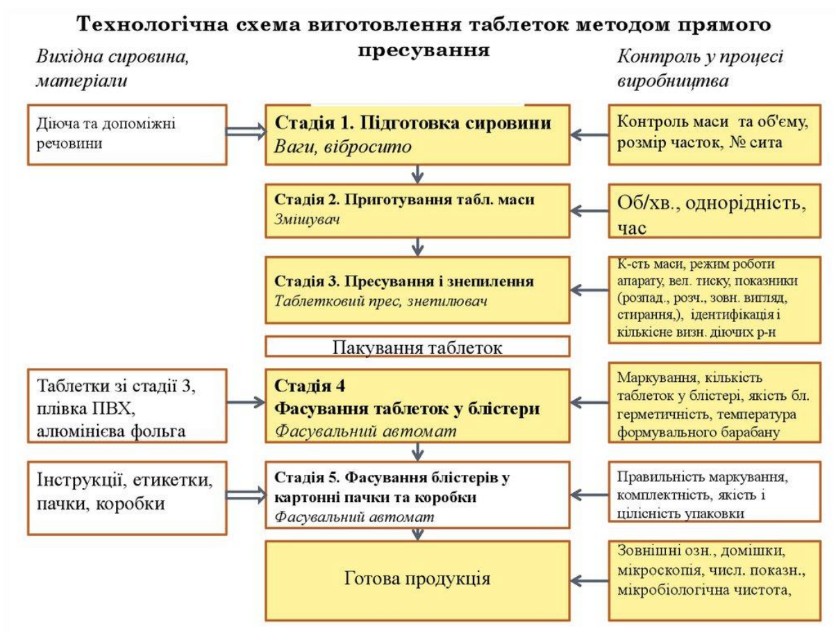
Рисунок 2.3. Технологічна схема виготовлення таблеток методом прямого пресування
