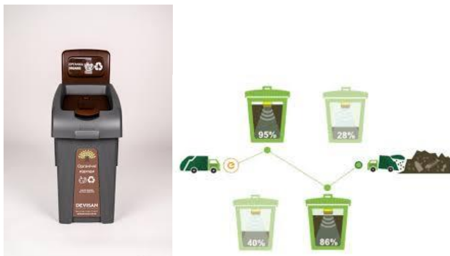
Рисунок 3.1 - "Розумні" контейнери з датчиками і принцип їх функціонування
