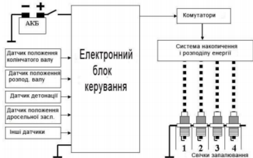
Рисунок 1.8 – МПСЗ бензинового двигуна [15].
