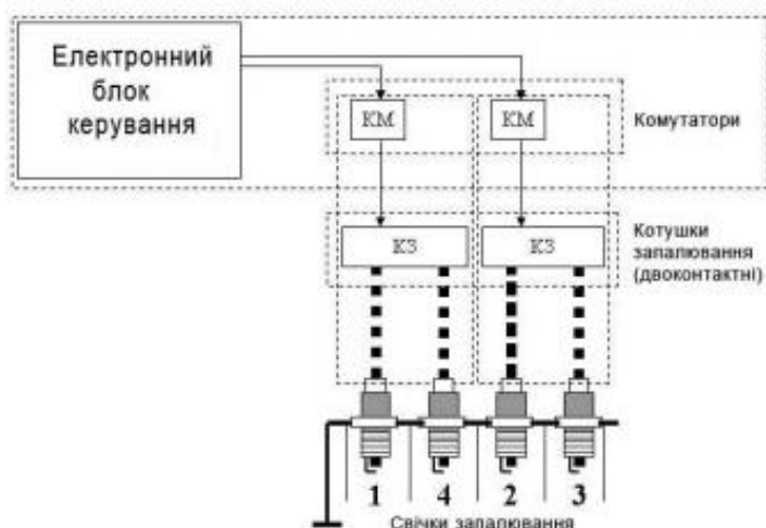
Рисунок 1.12 - Система запалювання DFS.
