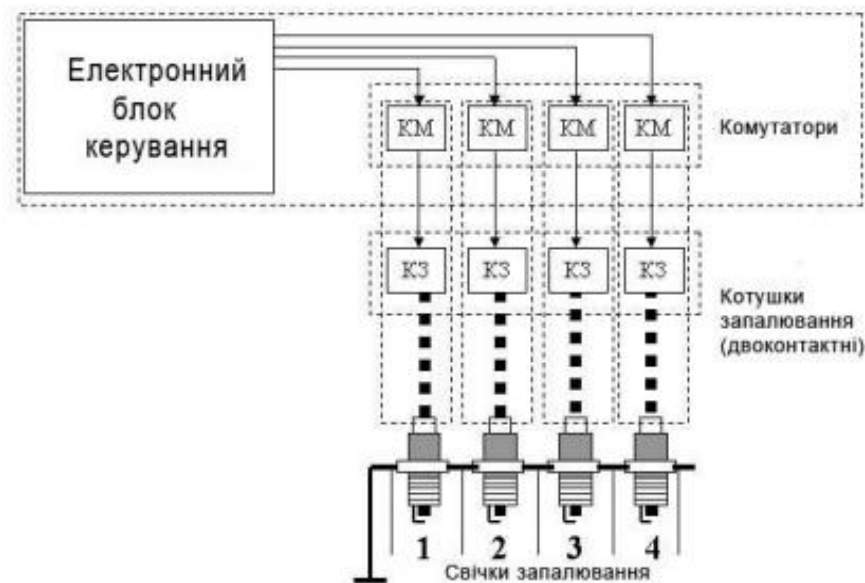
Рисунок 1.9 - Система незалежного запалювання [16].
