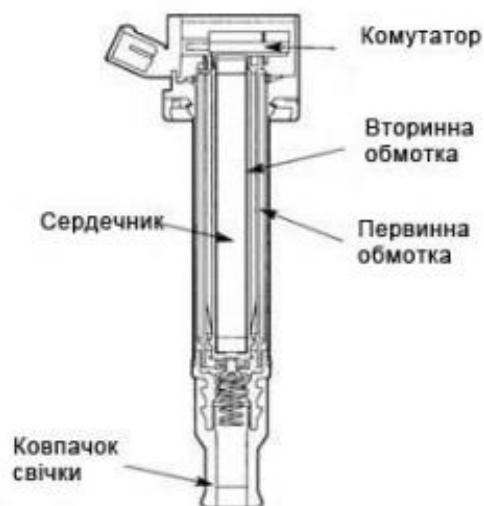
Рисунок 1.11 - Модуль запалювання системи COP
