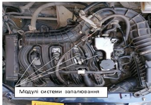
Рисунок 3.1 – Розміщення модулів системи запалювання інжекторного двигуна
