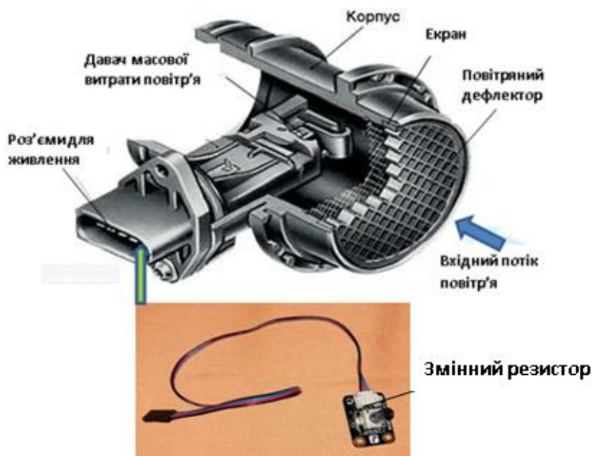
Рисунок 4.1 – Конструктивні елементи модернізованого давача
