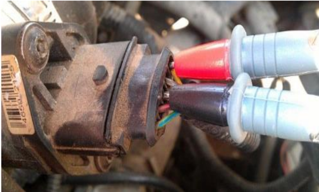
Рисунок 1.8 – Спосіб перевірки ДВП.
