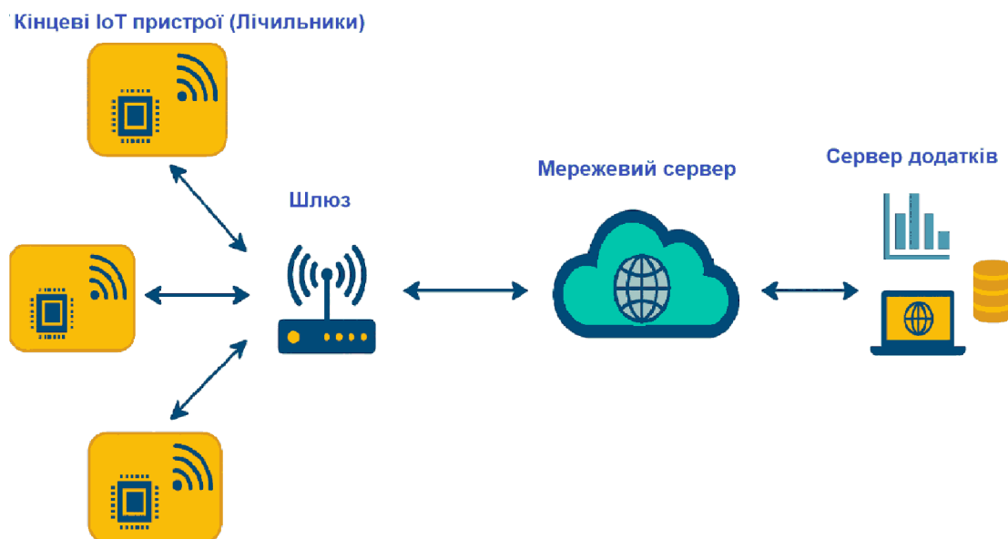
Рисунок 2.2 – Структурна схема системи моніторингу генерації та використання відновлюваної електроенергії на основі мережі LoRaWAN
