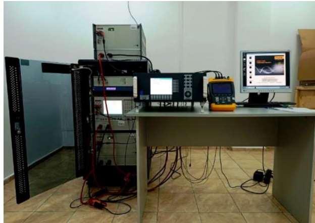
Рисунок 3.1 – Процес калібрування аналізатора якості електроенергії в Лабораторії електроенергетики та енергетики Інституту стандартизації та метрології України.
