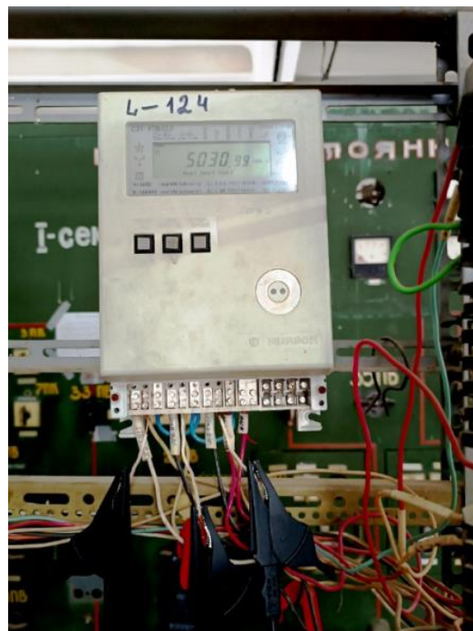
Рисунок 3.2 – Вимірювання робочих параметрів підключення трифазних аналізаторів якості електроенергії до «L-124».
