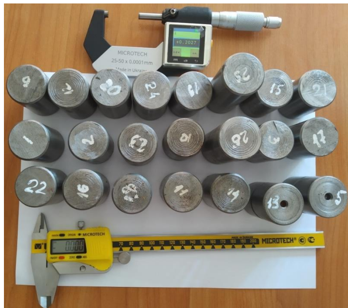
Рисунок 3.6 – Взірці валів для проведення дослідження зусилля монтажу та демонтажу та інструмент для визначення їхніх розмірів (фото)
