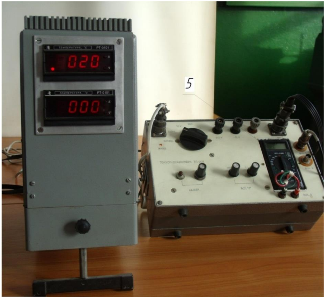
Рисунок 3.3. – АЦП та підсилювач цифрового сигналу: 5 – АЦП тензопідсилювача
