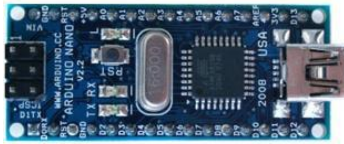
Рис. 3.5 – Програмований контролер Arduino Nano
