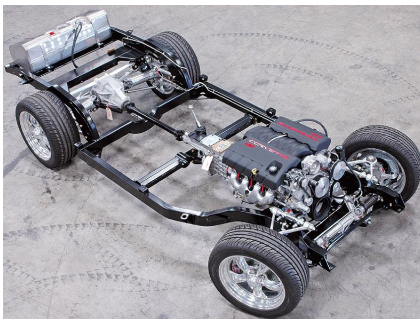
Рисунок 1.3 – Лонжеронна периферійна автомобільна рама
