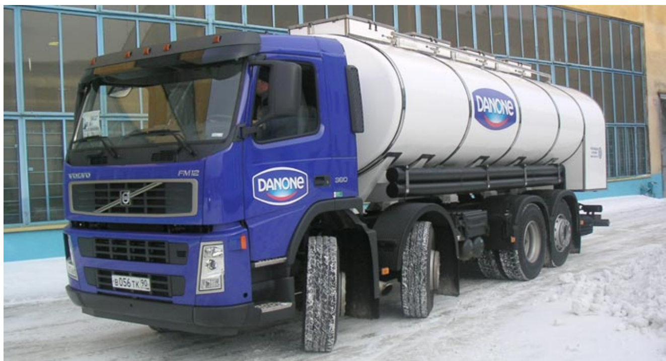
Рисунок 1.3 – Автоцистерна БЦМ-139 для рідких харчових продуктів
