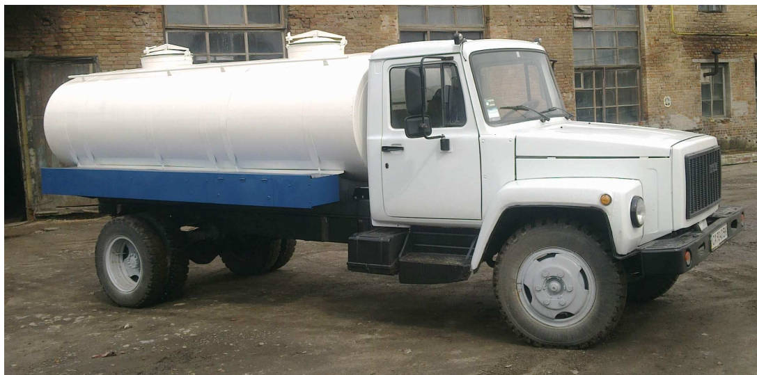
Рисунок 1.8 – Автоцистерна типу Г6-ОТА-4.2 призначена для перевезення різних харчових рідин (молоко, питна вода, квас) щільністю не більше 1,03 \text{ кг / дм}^3 .
