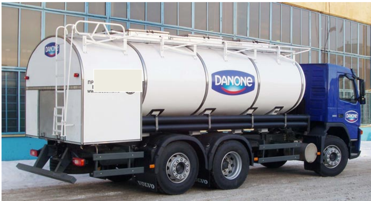
Рисунок 1.2 – Автоцистерна БЦМ-138 для рідких харчових продуктів
