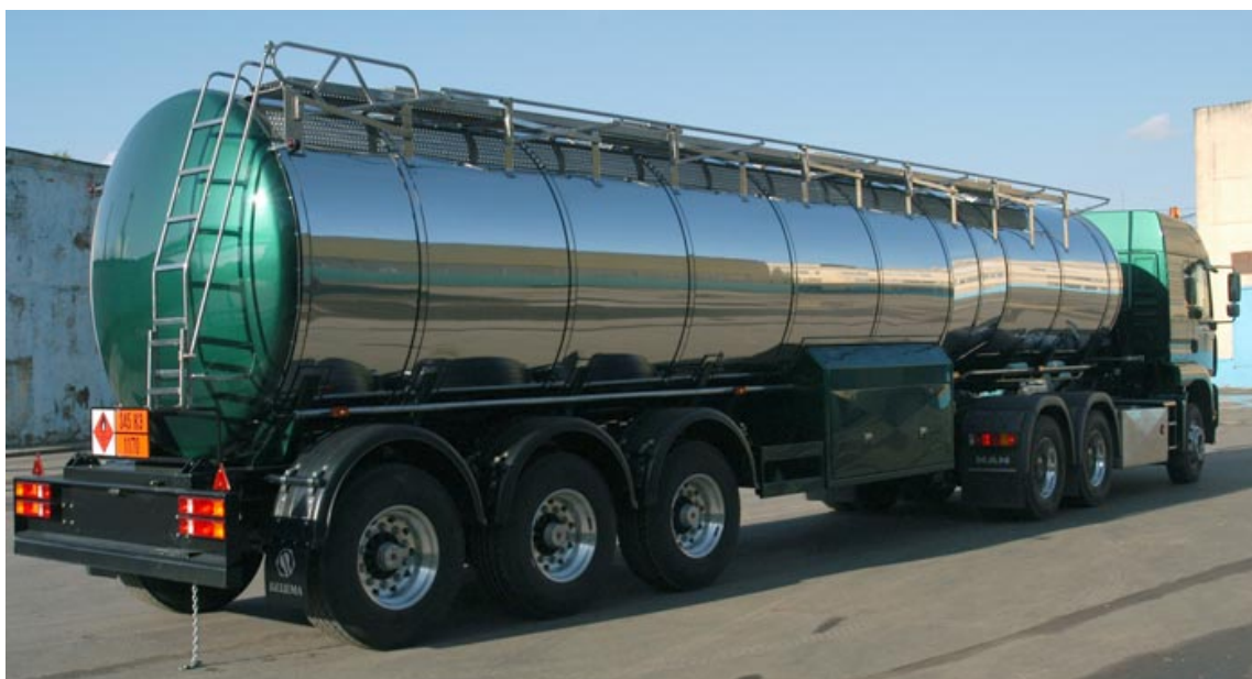
Рисунок 1.1 – Напівпричіп цистерна БЦМ-42.3 для рідких харчових продуктів
