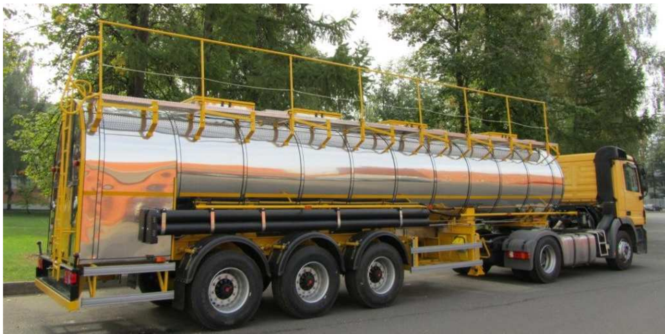
Рисунок 1.4 – Напівпричіп цистерна БЦМ-140 для рідких харчових продуктів
