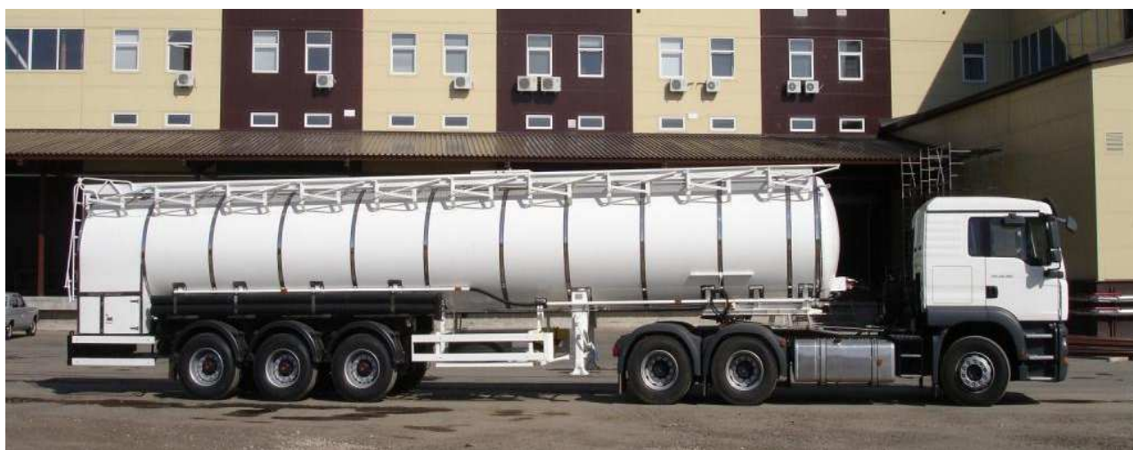
Рисунок 1.5 – Напівпричіп цистерна БЦМ-145 для рідких харчових продуктів
