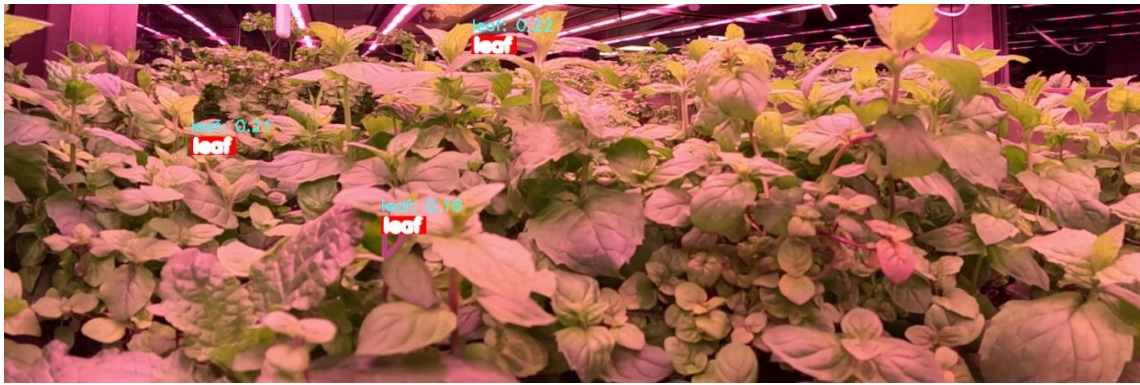
Рисунок 3.14 – Сегментація екземпляра після того, як YOLOv9e-seg було налаштовано на наборі даних Single plant
