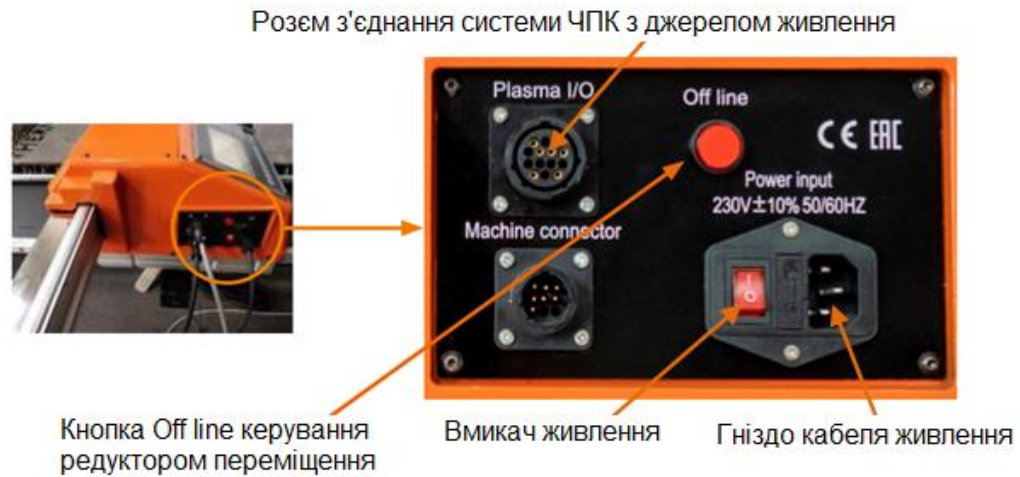
Рисунок 1.14 – Роз'єми на лівій стороні основного блока системи EX-TRACK
