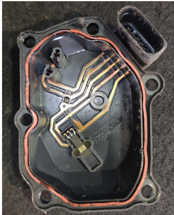
Рисунок 3.2 – Кришка дросельної заслінки із безконтактним датчиком положення
