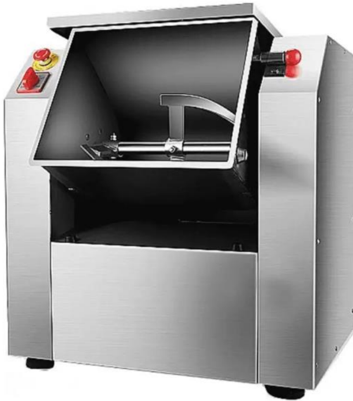
Рисунок 1.7 - Тістомісильна машина Hurakan HKN-25HN
