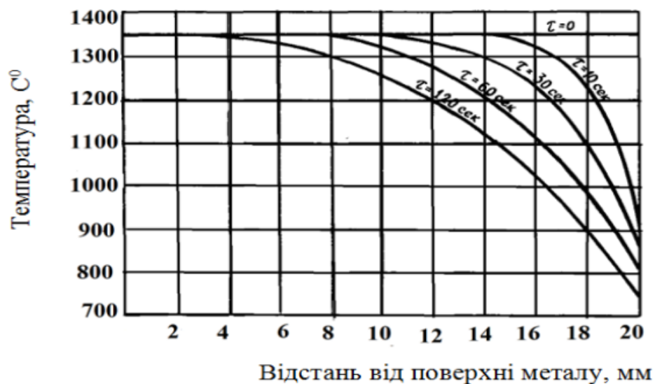
Рисунок 4.12 - Розподіл температури в шарі шлаків для різних моментів часу.
