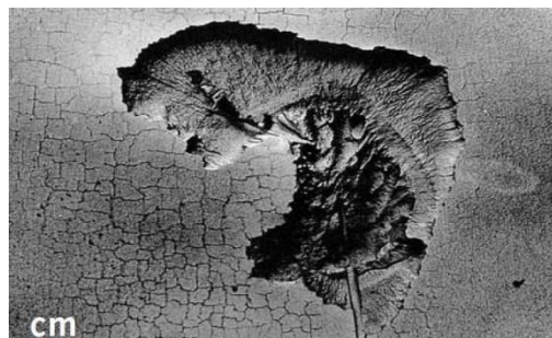
Рисунок 3.2 - Викришування на валку гарячої прокатки по сітці тріщин
