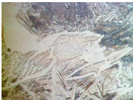
Рисунок 4.15 - Мікроструктура перехідної (а) і зони термічного впливу(б-г) при електрошлаковому наплавленні з підшаром зі сталі 45, \times 1000
