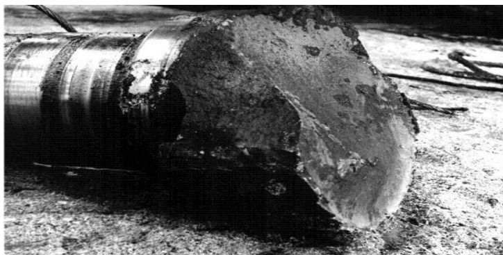
Рисунок 3.5 - Руйнування робочих валків виконання ЛПХНд-70 стану 1700 гарячої прокатки.
