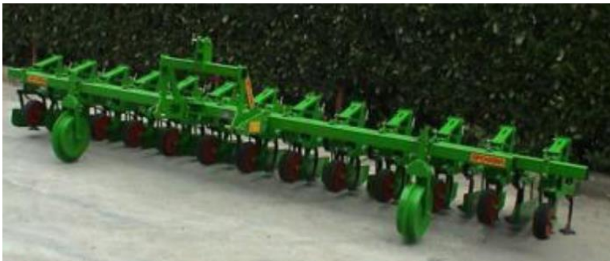
Рисунок 1.7 - Загальний вигляд культиватора ТЕМА-12
