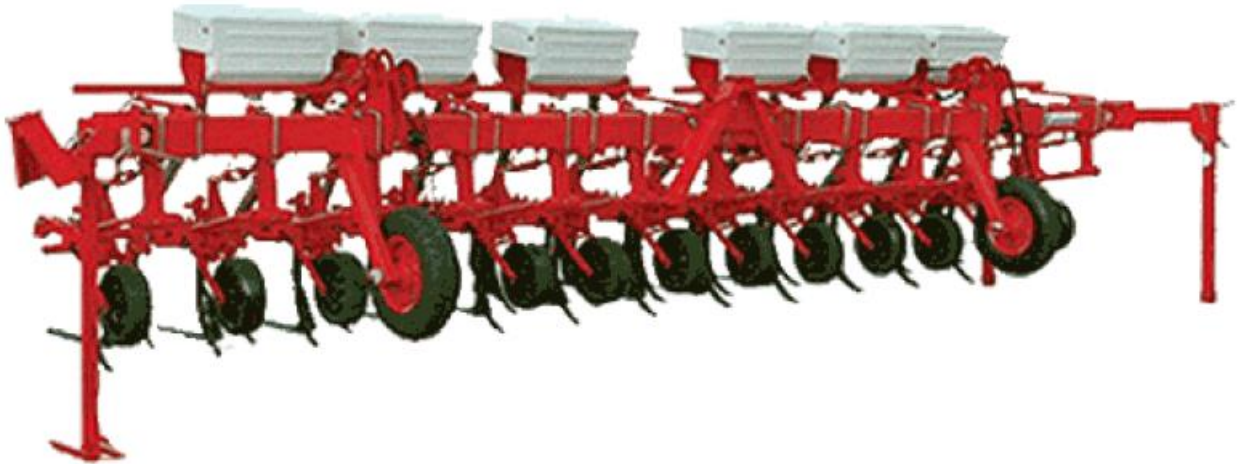
Рисунок 1.6 - Культиватор-рослинопідживлювач навісний високостебельний КРНВ-5,6-02
