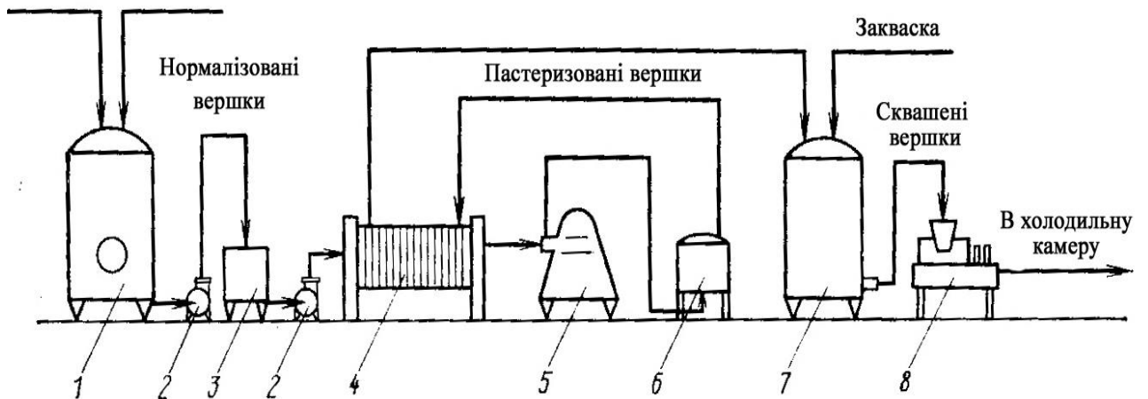
Рисунок 1.2 - Схема технологічної лінії виробництва сметани резервуарним способом:
