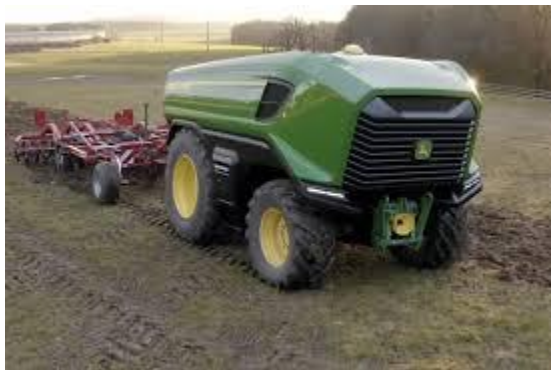
Рисунок В.2 - Безпілотний трактор від компанії John Deere.
