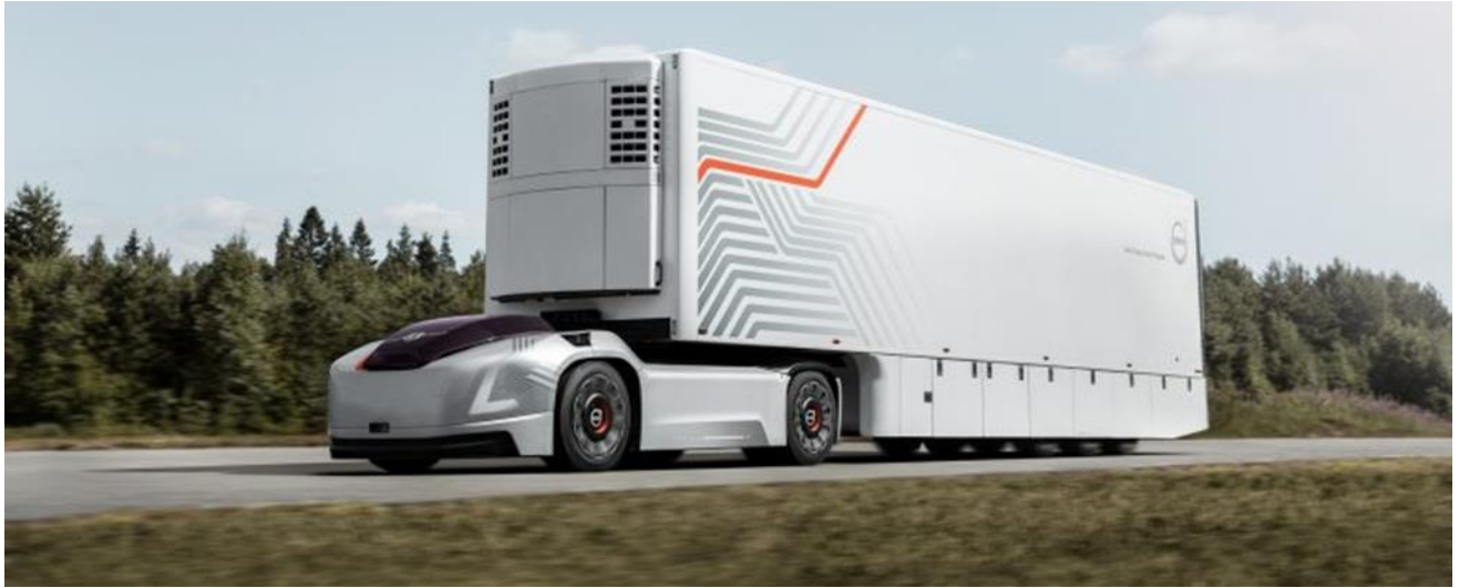
Рисунок В.1 - Безпілотний вантажний автомобіль VERA від компанії Volvo Trucks.
