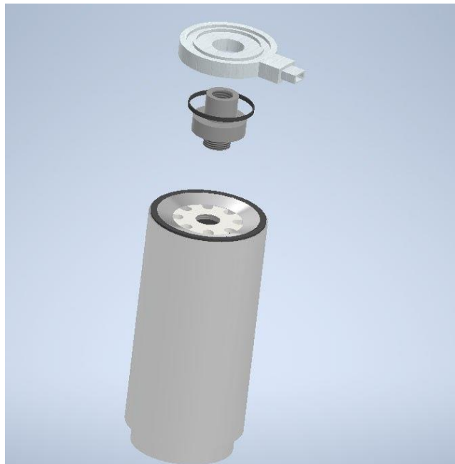
Рисунок 3.1 – Підігрівач дизельного пального індукційного типу
