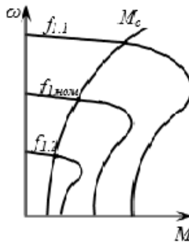
Рисунок 2.7 – Ілюстрація регулювання частоти напруги при використанні перетворювача частоти
