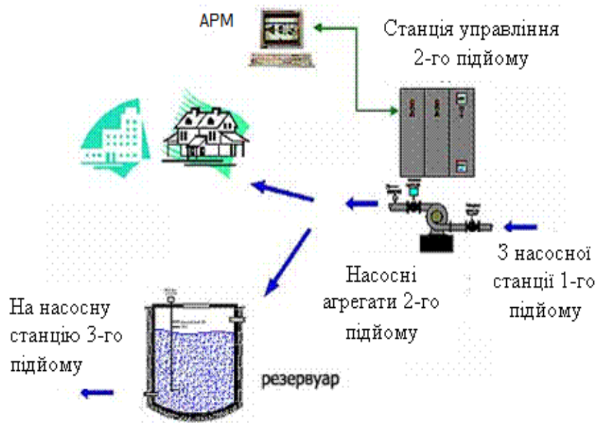
Рисунок 1.2 – Ілюстрація насосної станції другого підйому
