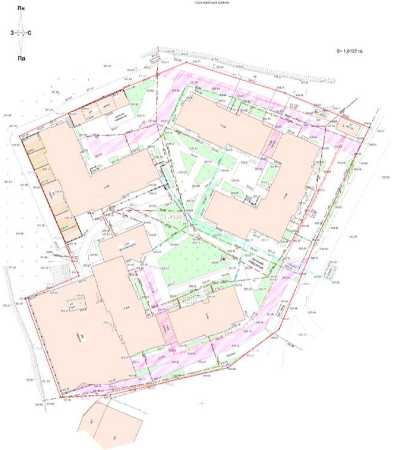
Рис. 4.5. План топографічного знімання 1:500 на територію навколо вулиці Шевченка 148, в м. Тернопіль.
