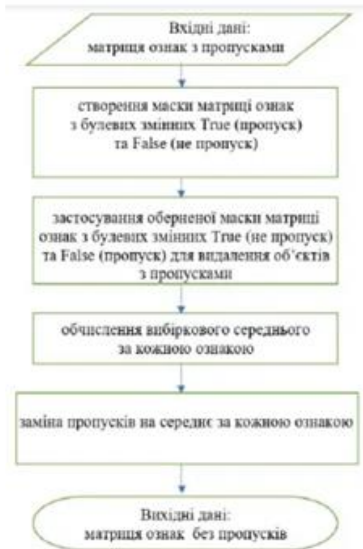
Рис. 2.6 - Алгоритм методу (Mean substitution, Mean) заповнення пропусків даних в таблицях середнім значенням відповідного параметру.
