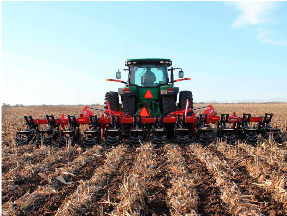
Рисунок 1.4 – Посів за технологією Strip-till
