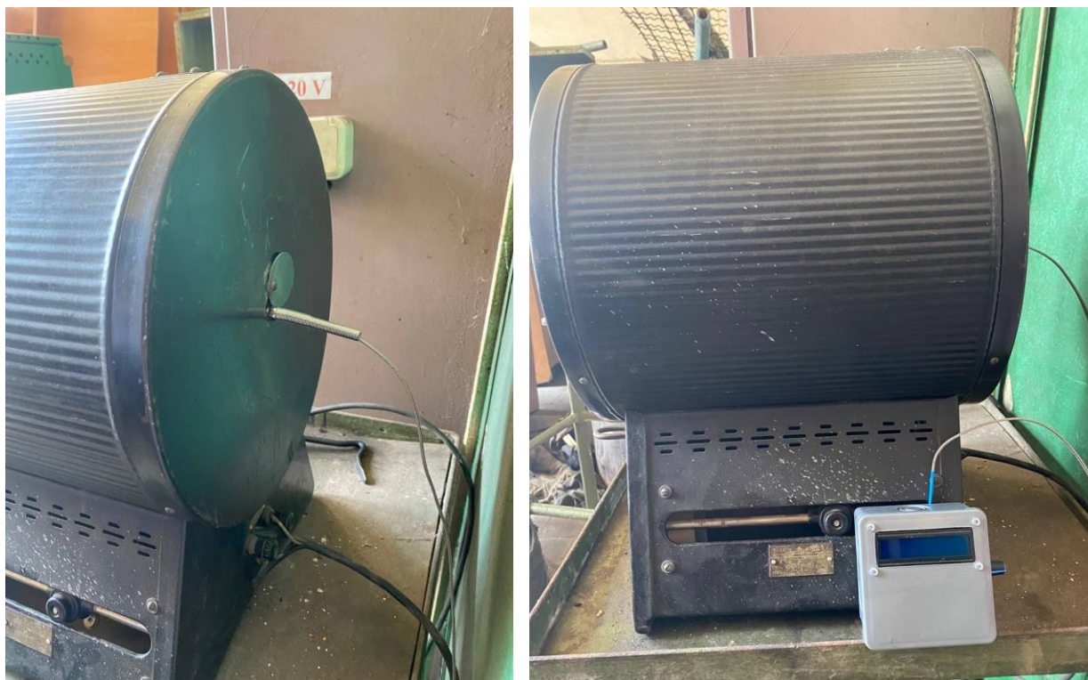
Рисунок 2.12. Муфельна піч з системою автоматизації її роботи
