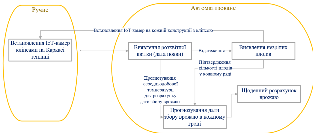
Рисунок 2.1 – Структура автоматизованої системи моніторингу стану помідорів у теплицях із використанням IoT-камер
