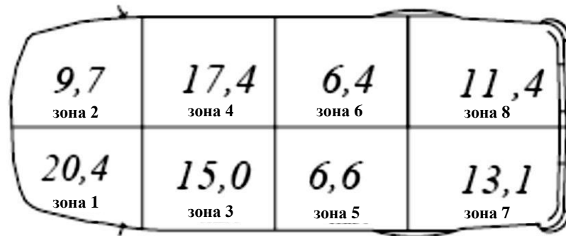
Рисунок 2.1 – Розташування зон травмонебезпеки в автобусі особливо малого класу під час лобових зіткнень
