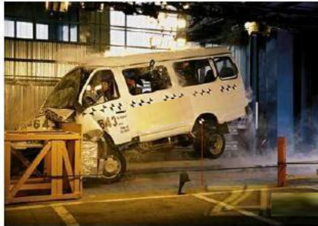
Рисунок 2.6 – Вид мікроавтобуса в момент креш-тесту
