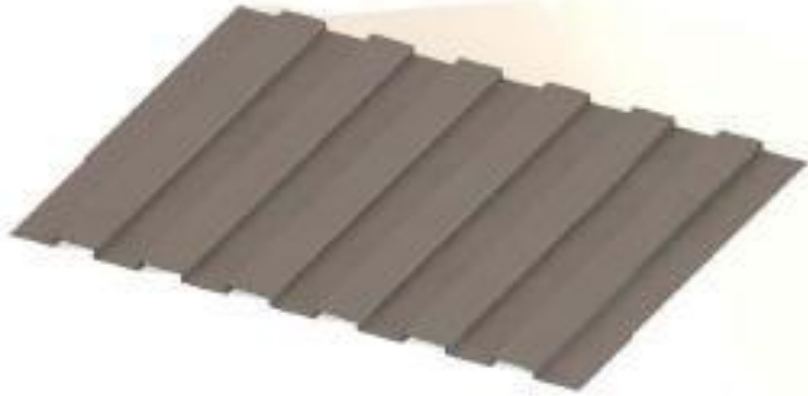
Рисунок 3.10 – Пропонована конструкція підлоги автомобіля зі штампованим профілем
