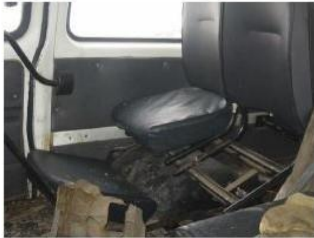
Рисунок 2.3 – Пошкодження у салоні мікроавтобуса після ДТП
