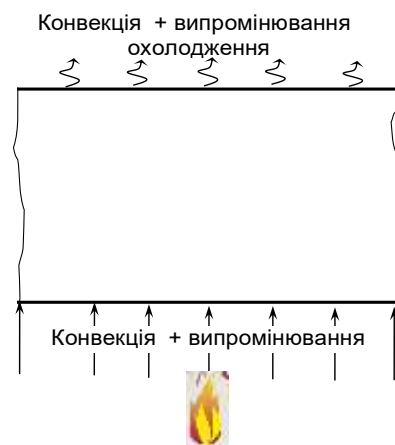
Рис. 4.2. Розрахункова схема до теплового розрахунку залізобетонної плити.
