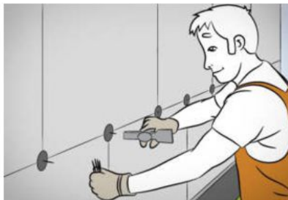
Рис. 3.9. Дюбелювання пінополістирольних плит.
