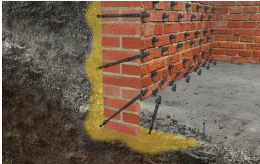
Рис. 3.2 - Приклад розташування ін'єкторів
