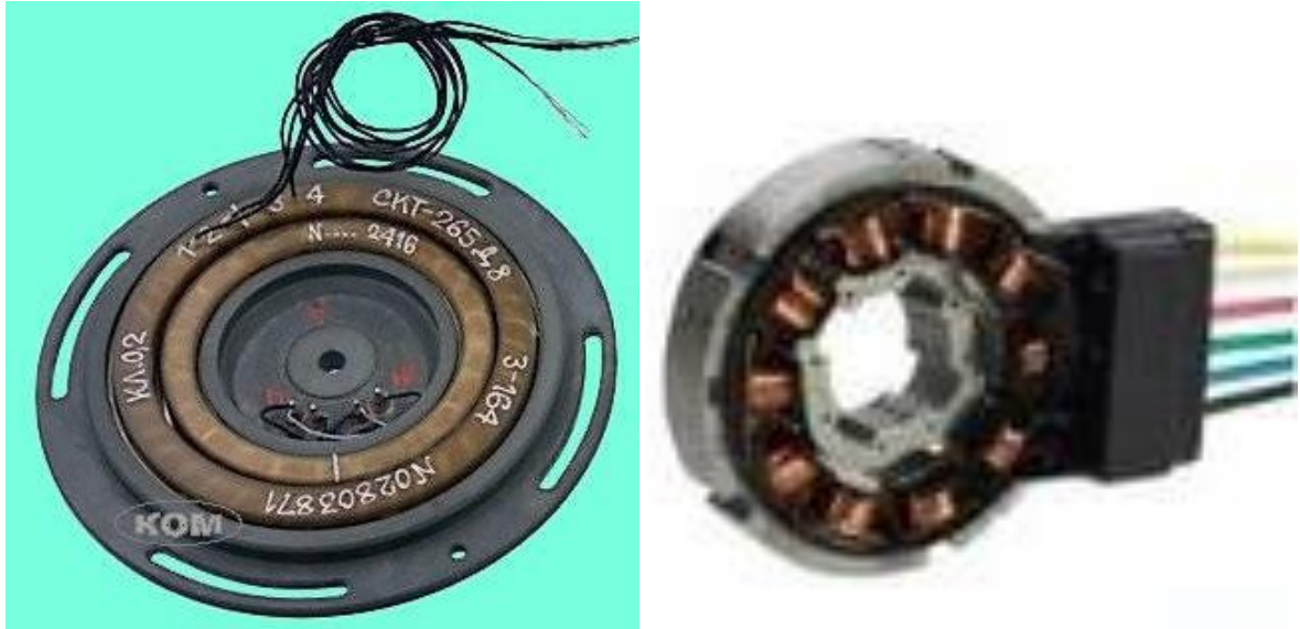
Рисунок 2.5 – Сенсор з обертовим трансформатором
