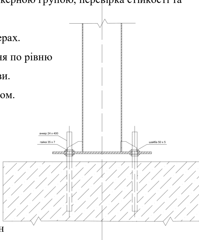
Рис. 2.1. Вузол приєднання колони до фундаменту
