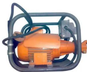
Рис.3.4. Глибинний вібратор IVA-3000
