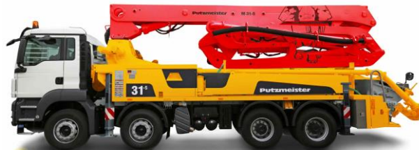
Рис.3.3. Бетононасос на автомобільному ході Putzmeister M 31-5
