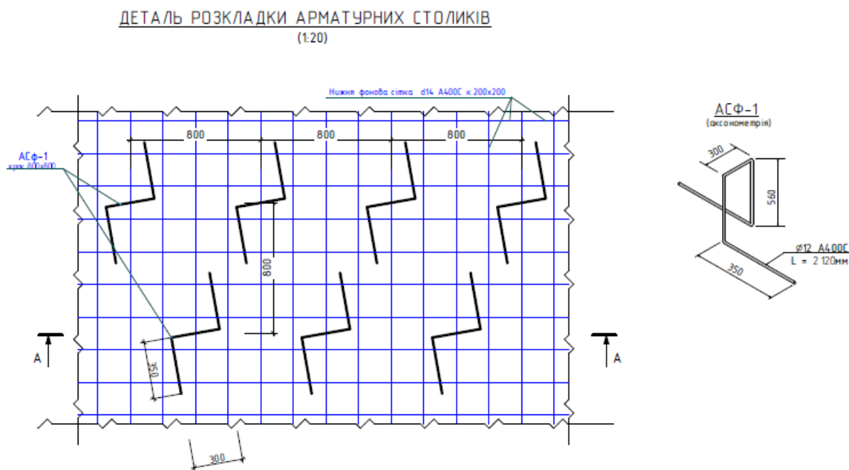
Рис.3.2 Забезпечення проектного положення арматури
