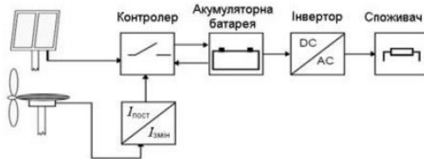
Рисунок 4 – Структурна схема типової гібридної енергетичної системи з використанням енергії вітру та сонця
